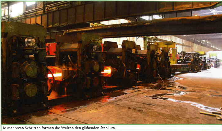
In mehreren Schritten formen die Walzen den glühenden Stahl um.
