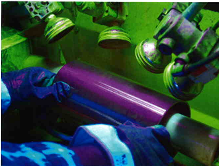
Bild 4: Per Hand wird geprüft, ob sich Risse im Werkstück gebildet haben
