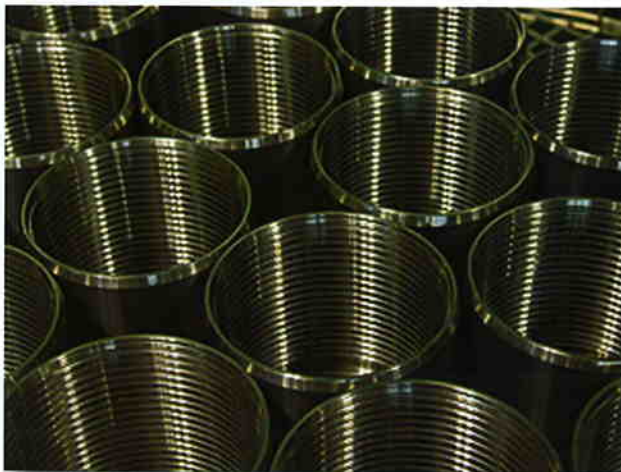
Bild 2: 75 Prozent der Rohre bestehen aus hoch legiertem Chromstahl, die übrigen 25 Prozent aus niedrig legiertem Stahl mit mittlerer Festigkeit (P110, C95 oder L80)
