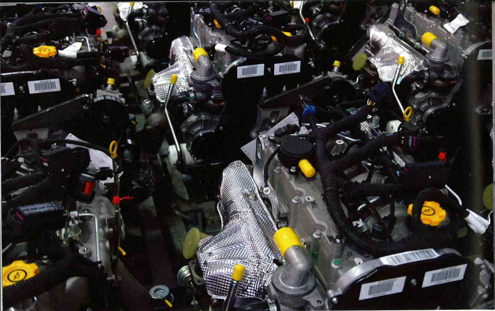
Bild 1: Fertig montierte Dieselmotoren bei VM Motori: Der Zusammenbau eines Motors nimmt rund 2,5 bis 3 h in Anspruch.
