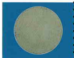
Filter nach Abguss mit ENVIBOND®
