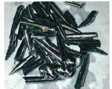
Cerazitit reklamiert, für das Zerspanen von Titan die RoadMap erfüllt zu haben: mit dem passenden Substrat, der geeigneten Beschichtung und optimaler Geometrie. Die Rollspäne sind zumindest ein Indiz für sicheren Prozess.
