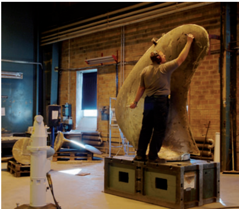
Laserunterstützt: Ein Mitarbeiter von Aerodyn misst die gegossene Schaufel aus und legt fest, wie sie zu fräsen ist. (alle Fotos: Ceratizit S.A.)
