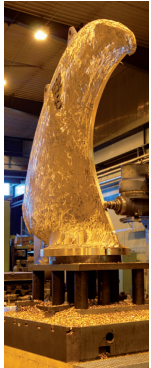
Bei einem Schaufelgewicht von 3,8 Tonnen liegt die Toleranz zwischen den Schaufeln bei nur sechs Kilogramm.
