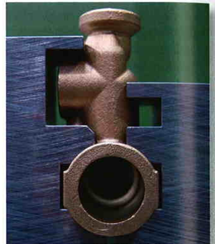
Bild 2: Ein typisches Produkt des JRG-Werkzeugbaus: eine Werkstückspannbacke, die das Gussstück bei der Bearbeitung bombenfest an der richtigen Position hält
